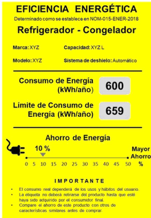
**Figura 1-Ejemplo de la distribución de la información de la etiqueta de refrigeradores y congeladores electrodomésticos.**
