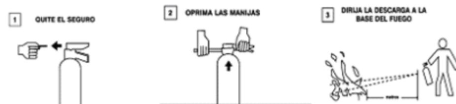
Figura 11- Ejemplo de imágenes y leyendas que ilustran la nemotecnia de operación de los extintores portátiles
