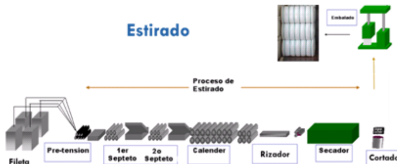
Proceso de estirado del PFC fabricado por DAK
